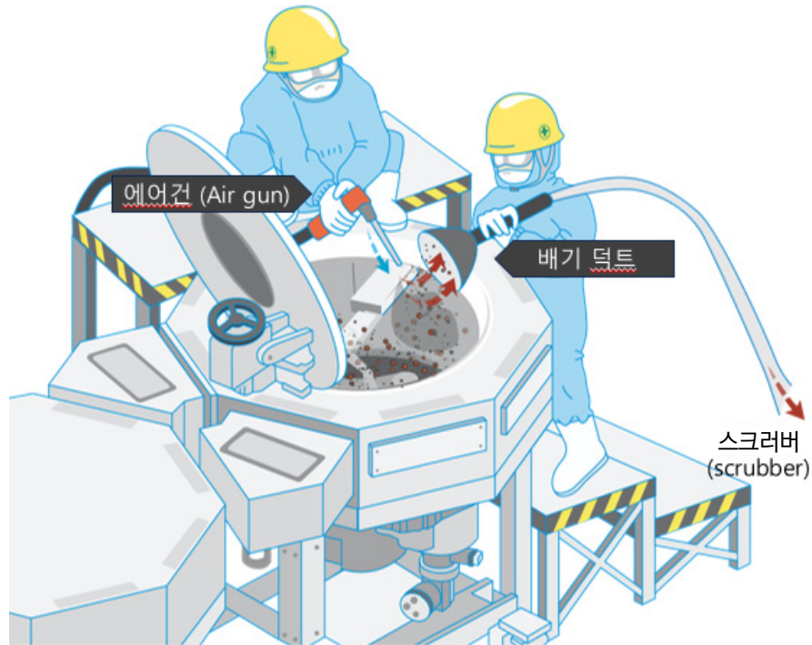
[그림 6] 공정 설비 정비 작업 중 에어건 사용 시 배기 덕트 병행해서 사용
