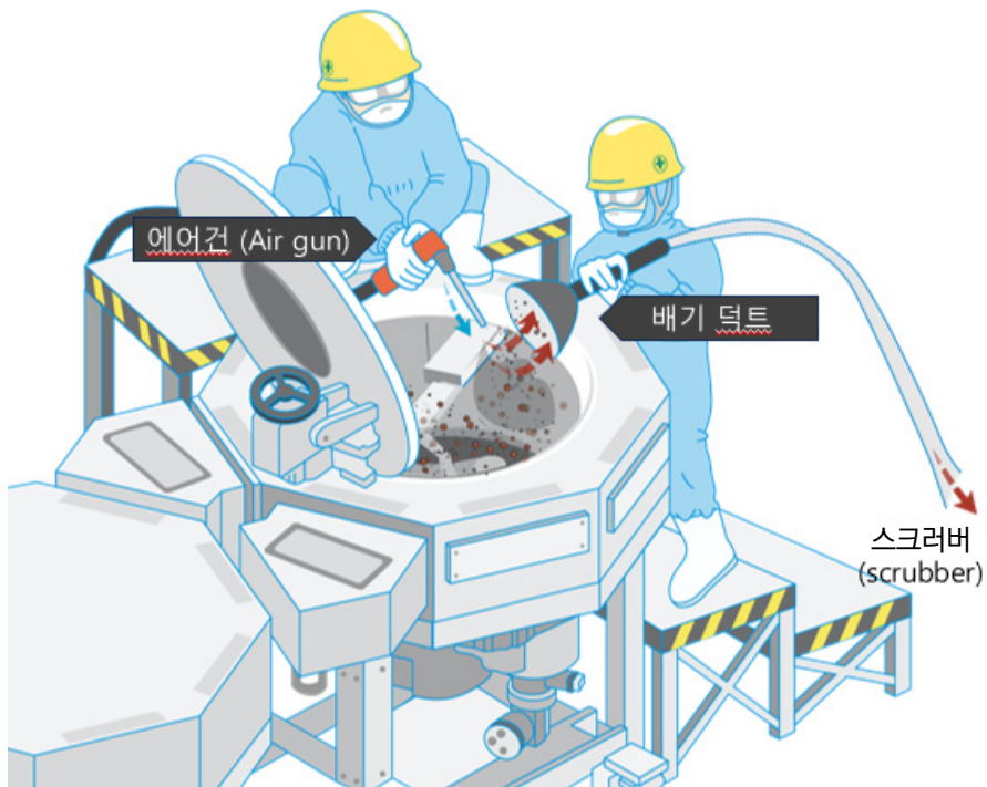
[그림 5] 공정 설비 정비 작업 중 에어건 사용 시 배기 덕트 병행해서 사용
